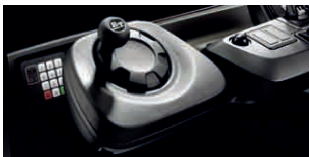
BT Reflex N-seriens elektroniske, progressive 360° styring er måske det vigtigste bidrag til køreoplevelsen
