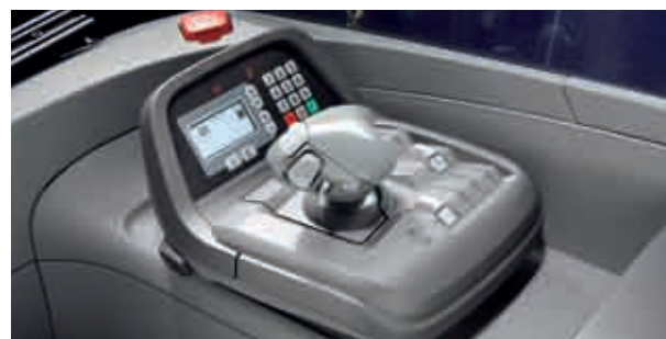
Der kan også vælges multifunktionsgreb (joystick), alt efter, hvad din virksomheds førere foretrækker eller har erfaring med
