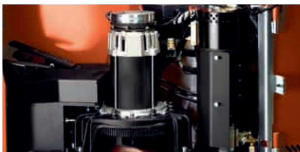
Da der ikke anvendes kulbørster og strømkontakter i vekselstrømsmotoren, er nedetiden, grundet vedligeholdelse, reduceret
