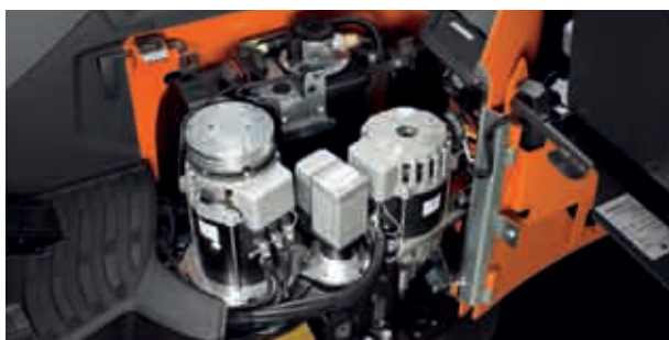
BT Reflex R-serien har indbygget holdbarhed, med forseglede elektriske enheder, børsteløse motorer og lækagefrie hydraulikforbindelser
