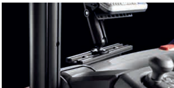
E-baren (ekstraudstyr), der er beregnet til montering af ekstraudstyr, har en standardgrænseflade og indbygget strømforsyning
