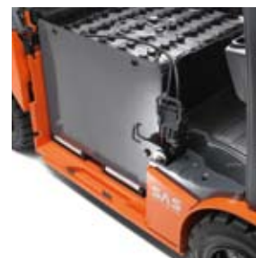
Sideudtagning af batteri med rulleje
